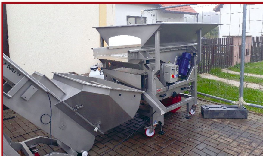
Vibračný stôl Delta TRV 20 so zvýšenými bočnicami.
